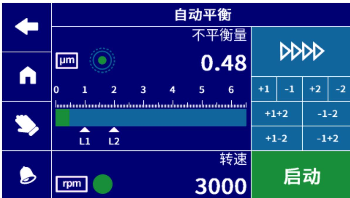
点击启动后，一个半自动平衡循环开始。直至振动量小于 L1 设定范围后停止。
