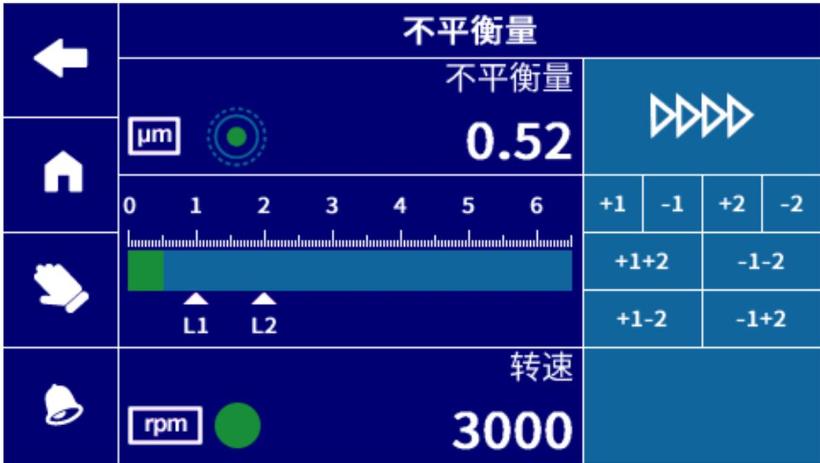
在自动工作状态下，控制仪的平衡操作取决于与机床间连接信号的状态。
